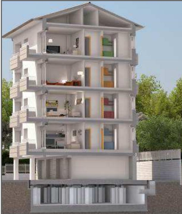
**Sottostruttura** costituita da fondazione diretta a platea, muri di contenimento e colonne di supporto in c.a. per gli isolatori;
