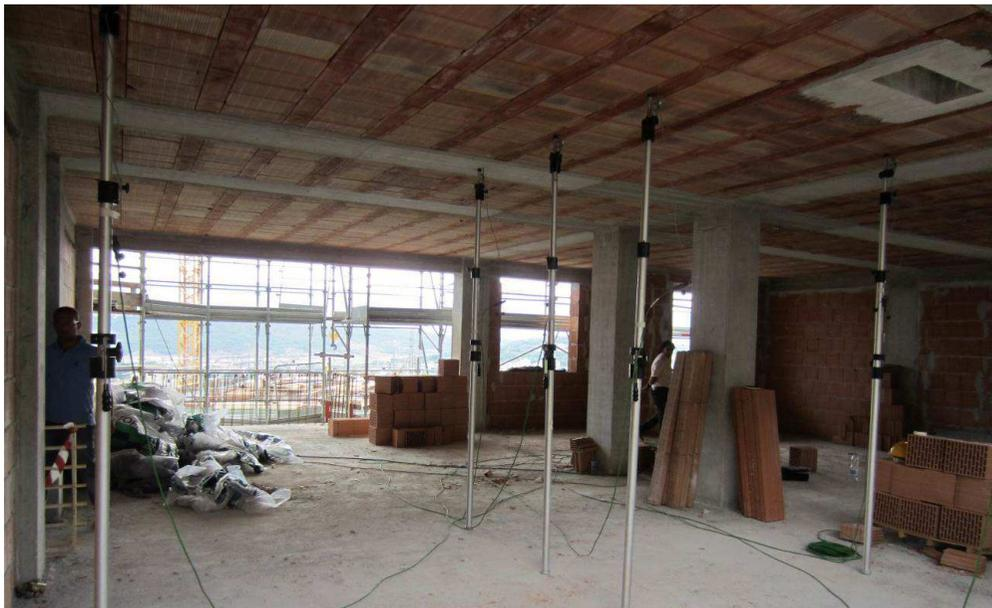
Gli spostamenti verticali sono stati misurati con trasduttori elettrici fissati su aste telescopiche in alluminio e posti in contrasto con l'intradosso della struttura oggetto di prova.
