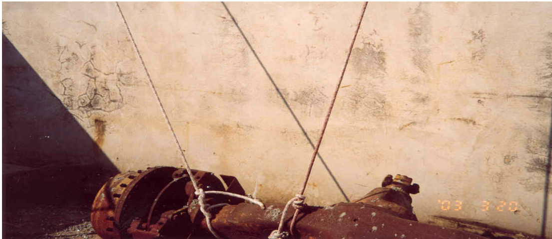
Fig. 14 Modalità di ancoraggio di una imbragatura di sicurezza (semiasse camion)
